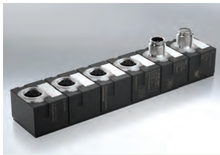
MICO67-Standard-4.4 protejează și distribuie energia la 24 V DC direct în teren, prin intermediul a patru ieșiri protejate electronic, cu un curent de până la 4 A per canal.
