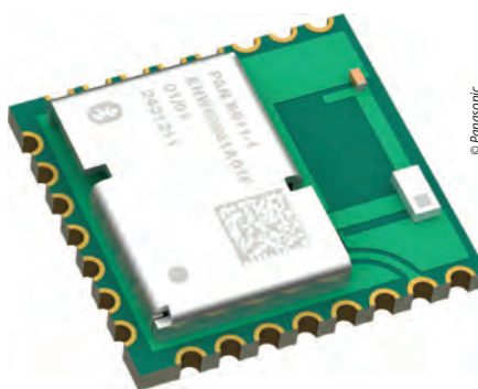
Figura 3 Modulul PAN-B611 cu antenă integrată.
