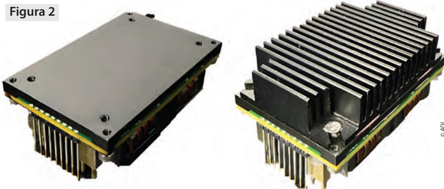
Modulul QBM cu placă de bază plană și radiator extins disponibil comercial.
