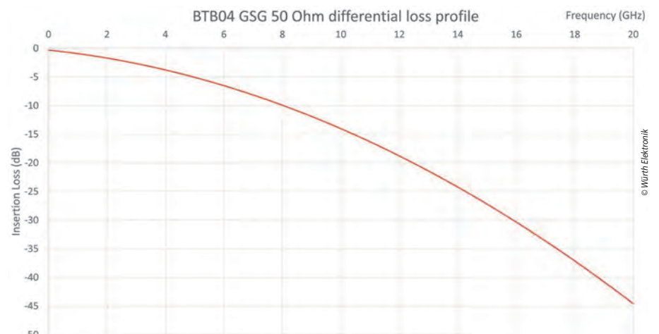
Figura 3 Curba de atenuare pentru seria BTB de mare viteză, cu profil redus și pas de 0,4 mm, în configurație GSG de 50 Ω.
