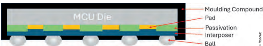
Figura 1 Structura internă simplificată a capsulei WLCSP.
