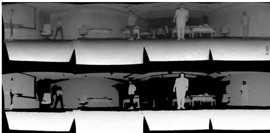
Figura 9 Imagini IR și de adâncime îmbinate, cu un câmp vizual de 278°.
