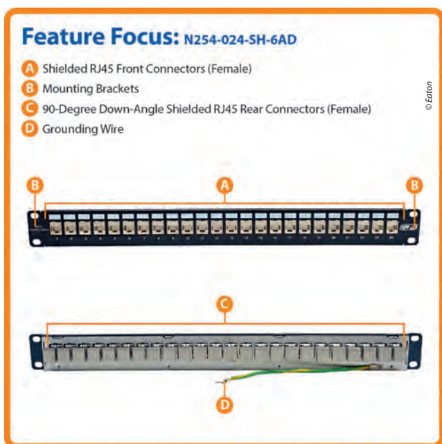
Figura 5 Panoul patch industrial Eaton (modelul N254-024-SH-D) evidențiind caracteristicile industriale cheie.
