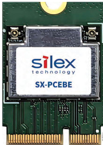
Placa Wi-Fi 7 M.2 SX-PCEBE de la Silex.
