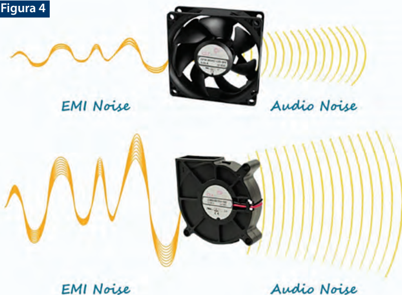
Compararea EMI și zgomotului audio la ventilatoarele axiale și centrifuge.
