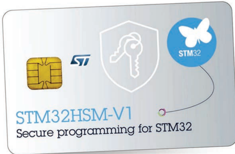
Figura 1 Dispozitivul STM32HSM-V1 HSM al STMicroelectronics este utilizat pentru a securiza programarea produselor STM32.
