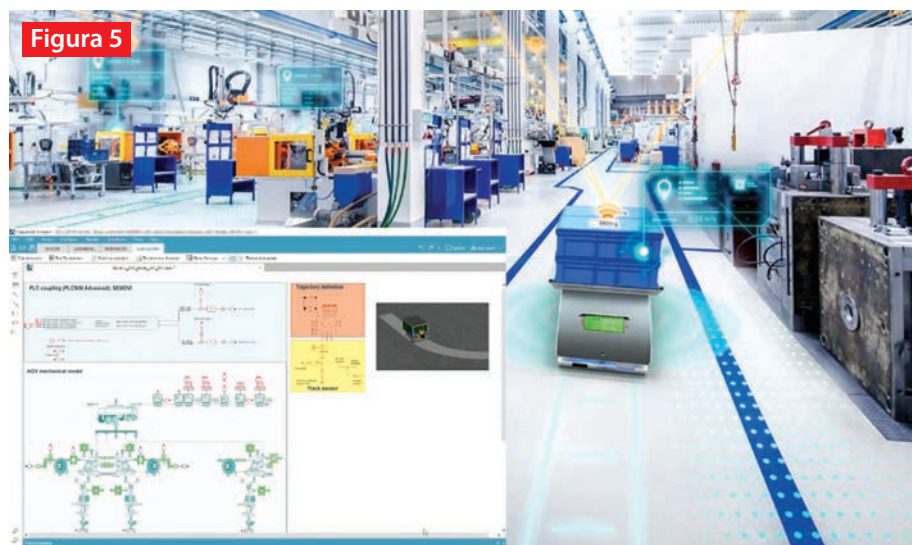
Gemenii digitali ai AMR-urilor pot fi introduși virtual într-un mediu de fabrică simulat pentru punerea în funcțiune virtuală.
