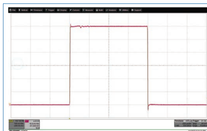
Figura 4a Răspunsul în trepte al mostrei supraturate (100A/Div & 200μs/Div).
