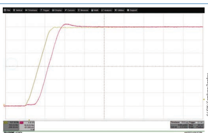
Figura 4b Răspunsul în trepte al mostrei supraturate (100A/Div & 5μs/Div).
