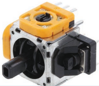
Comutator cu pârghie utilizat în multe modele de controlere.
