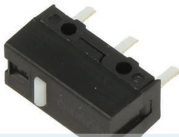
Comutator tipic SNAP ACTION de la un mouse de calculator.
