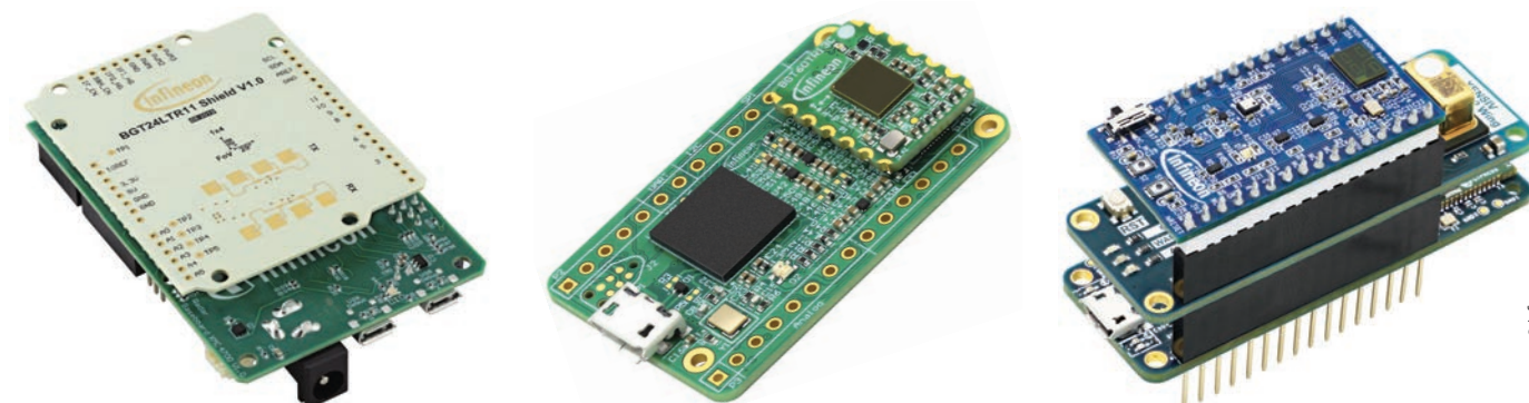
Figura 3 Kiturile de dezvoltare vin în completarea senzorilor radar: demo Distance2goL de 24 GHz (stânga), demo BGT60TR13C MMIC (centru) și kit de senzori conectați de 60 GHz (dreapta).
