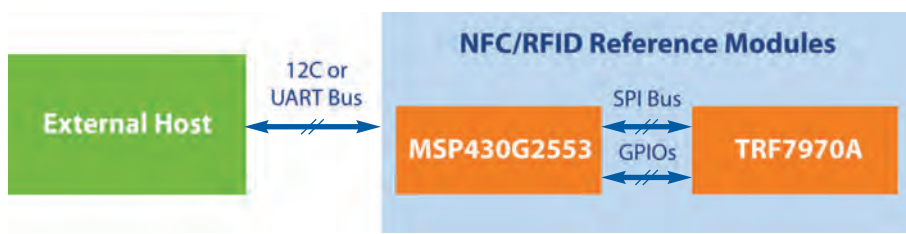
Figura 3 Diagrama bloc a hardware-ului unui transceiver NFC/RFID care utilizează modulele NFC/RFID TRF7970A și MSP430G2553 de la Texas Instruments.
