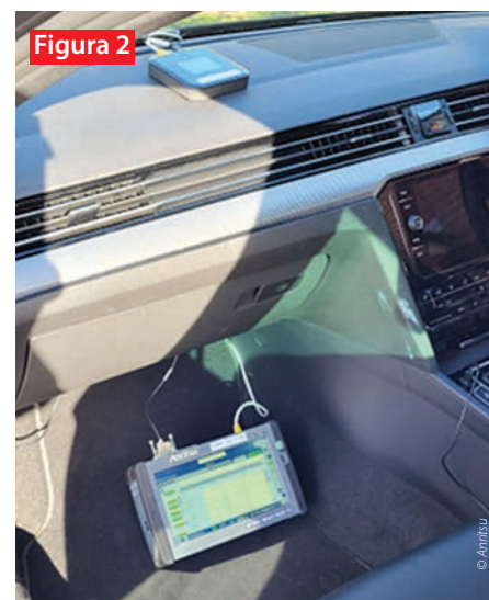
Figura 2 Echipamentul Anritsu MT1000A Network Master măsoară simultan latența legăturii ascendente (up-link) și descendente (down-link) în timpul unui drive test.
