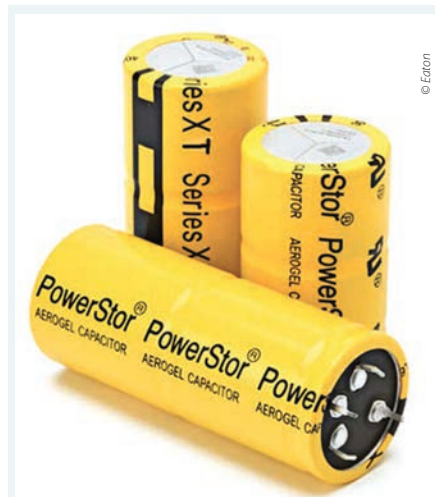
Eaton – Familia de supercapacitoare XT variază de la 275F la 555F/3V, cu temperaturi -40°C ... +85°C. Utilizare: stocare de energie de sine stătătoare sau în combinație cu baterii pentru a prelungi durata de funcționare.
