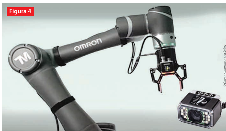
Figura 4 Citoarele de coduri de bare de înaltă performanță pot decoda rapid și fiabil codurile de bare 1D și 2D. Unele se montează pe efectorii finali ai roboților pentru a permite preluarea pieselor electronice și auto, precum și a diferitelor subansamble.
