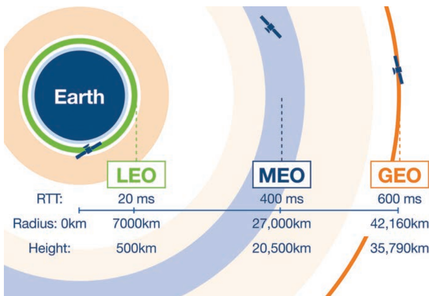
Figura 1 Localizarea orbitelor GEO, MEO și LEO în raport cu Pământul, cu indicarea distanței și a latenței călătoriei dus-întors.
