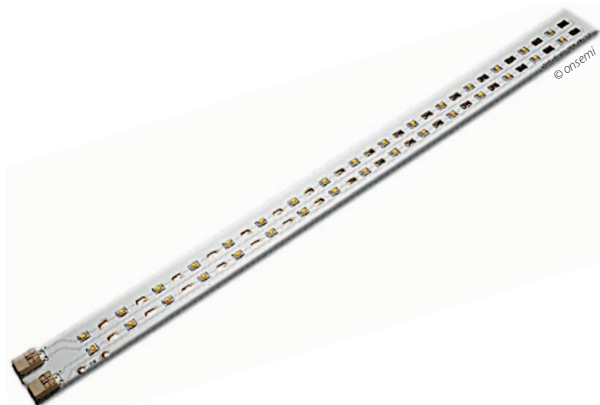
Figura 1 Două șiruri a câte 16 LED-uri fiecare pentru utilizarea în corpurile de iluminat inteligente.
