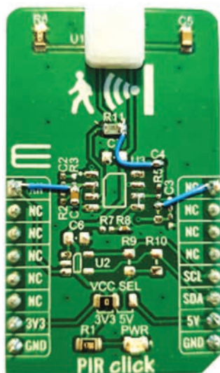
Figura 3 Placa PIR click modificată și schema electronică.
