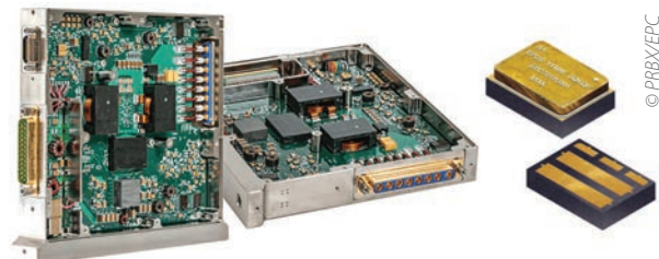
Figura 8: FET GaN EPC (Efficient Power Conversion) robust pentru aplicații spațiale și convertor DC/DC.
