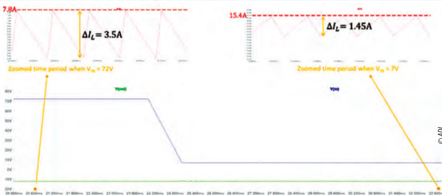
Figura 10 Măsurarea \Delta I_L la V_{IN} = 7V și 72V și extragerea curentului de vârf al bobinei cu circuitul LTspice anterior.
