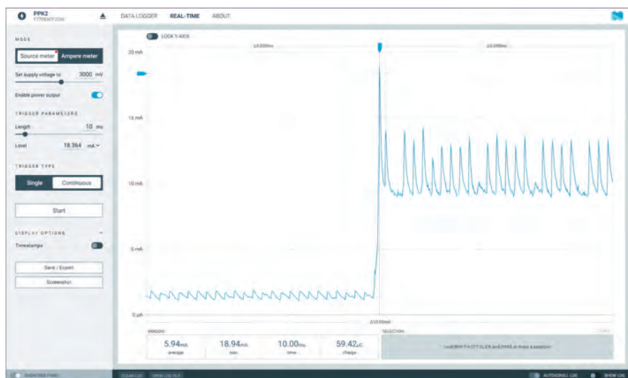
Figura 4. O captură de ecran a aplicației Power Profiler care efectuează măsurători de curent în timp real.
