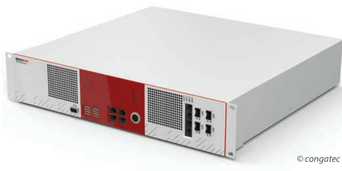
Serverul rack 2U secunet Athene oferă performanțe ridicate pentru procesele care necesită resurse și calcul intensiv și se bazează pe modulele de server COM-HPC de la congatec.
