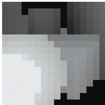
Reprezentare grafică a datelor obținute de senzorul VL53L1 (alb->8cm, negru->4m)
