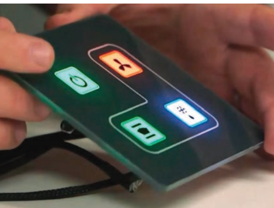
Comutatoare tactile capacitive montate pe un panou particularizat.
