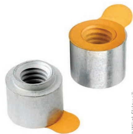
Figura 1 Terminalul industrial REDCUBE SMD 7466003R are o amprentă mică de 8,3 mm și este prevăzut să poată transporta în siguranță până la 50A. Este livrat cu o folie de protecție Mylar portocalie, care este îndepărtată de echipamentul automat de preluare și amplasare, înainte de montarea pe suprafața a acestuia pe cablajul imprimat.
