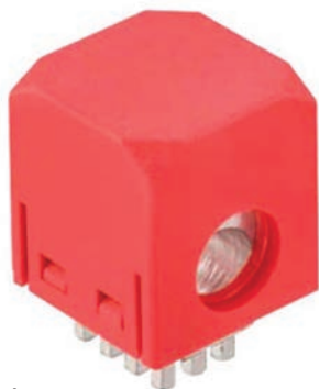
Figura 4 Conectorul REDCUBE PLUG 7464000 este un terminal cu montare prin presare, cu un curent nominal de 120A la 20°C. Oferă conectare și deconectare ușoară pentru curent mare, ceea ce îl face adecvat pentru soluții de alimentare reconfigurabile.
