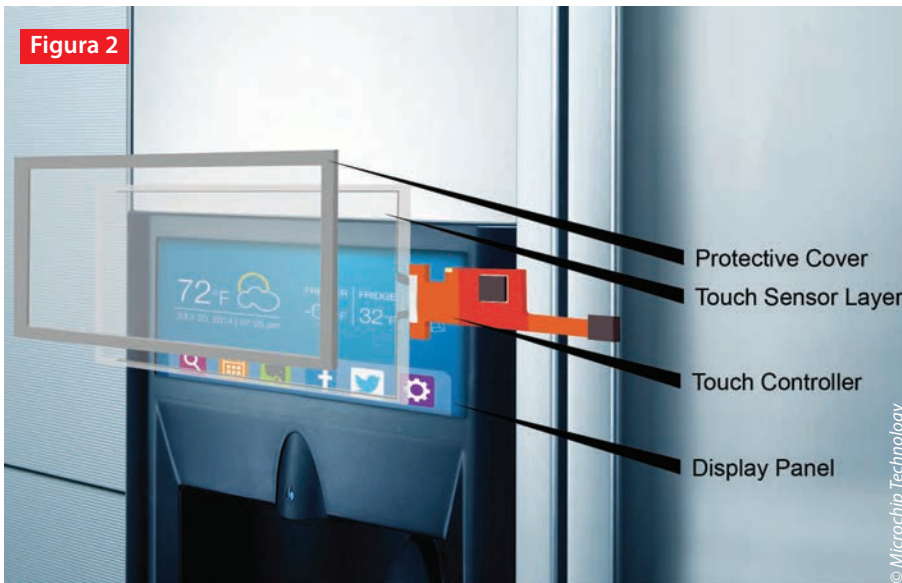
În spatele ecranului tactil, o matrice de electrozi de comandă, electrozi de recepție și circuitele din dispozitivul integrat tactil detectează cu fidelitate atingerea utilizatorului.
