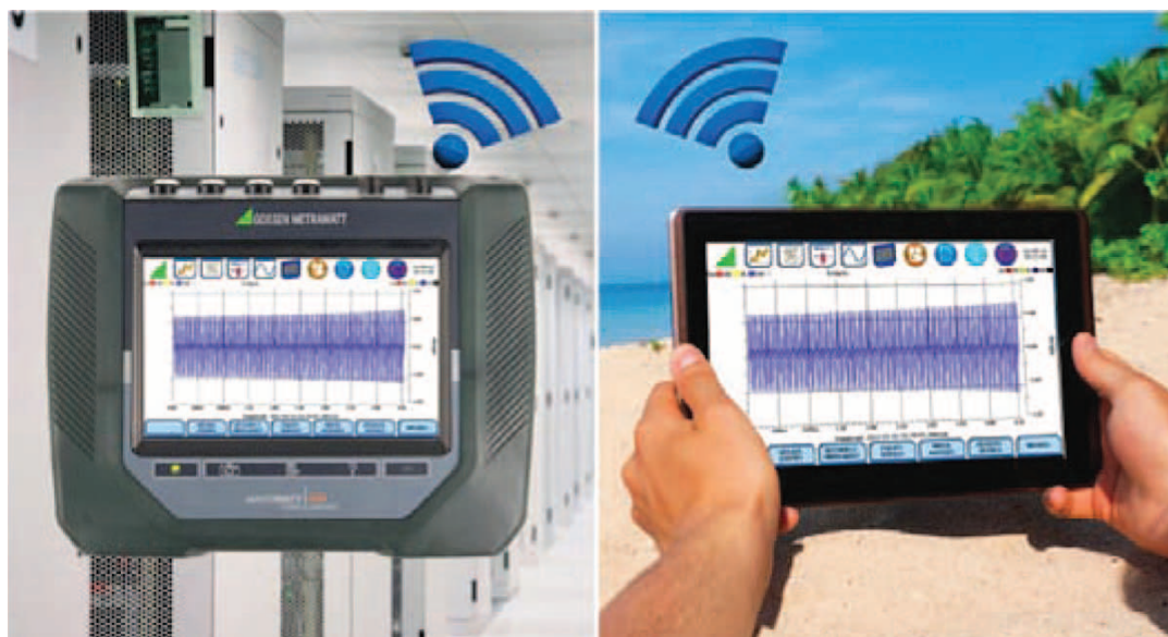
Figura 2: Comunicația la distanță dintre MAVOWATT 2xx și o Tabletă.
