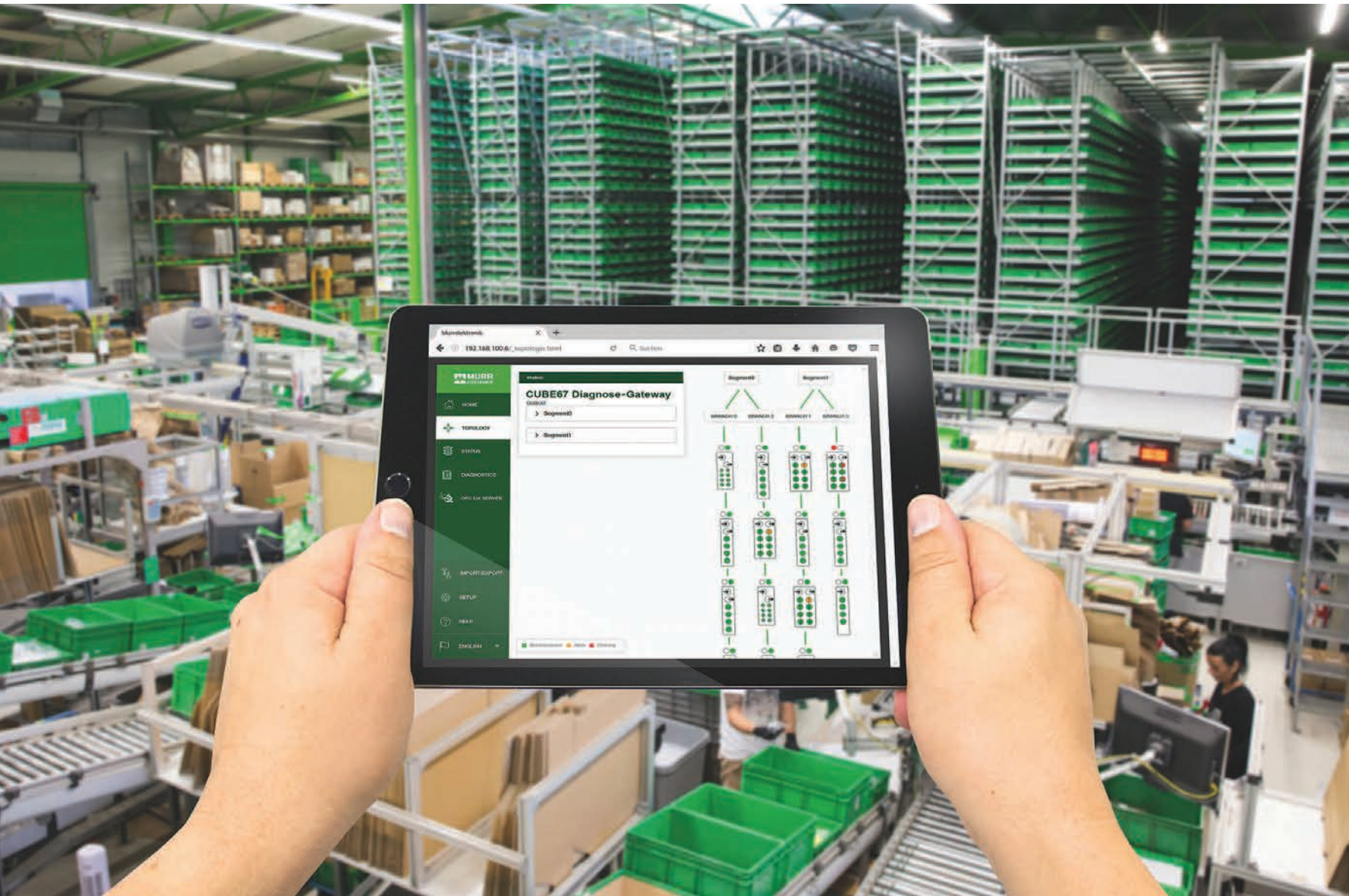
Pe ecran va fi afișată automat ordinea modulelor sub forma unei topologii clare.
