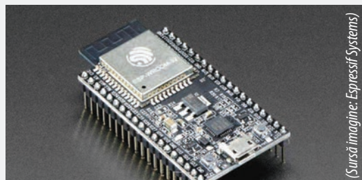
Figura 3: ESP32-DEVKITC de la Espressif Systems ghidează toți pini modulului Adafruit 3320 către un conector cu pini de 0.1 inch, încorporează un cip adaptor serial USB la TTL, butoane de programare și reinițializare, precum și un stabilizator de tensiune de 3.3V
