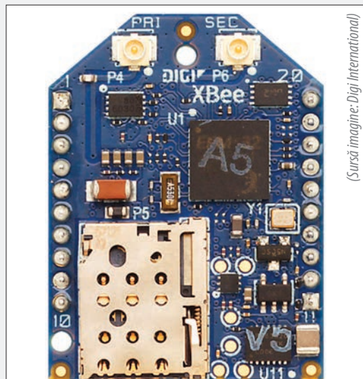
Figura 4: Modulul radio celular XBC-V1-UT-001 Xbee, LTE Cat 1 de la Digi International pune un sistem embedded în rețeaua celulară de comunicații a Verizon pentru câțiva dolari pe lună.
