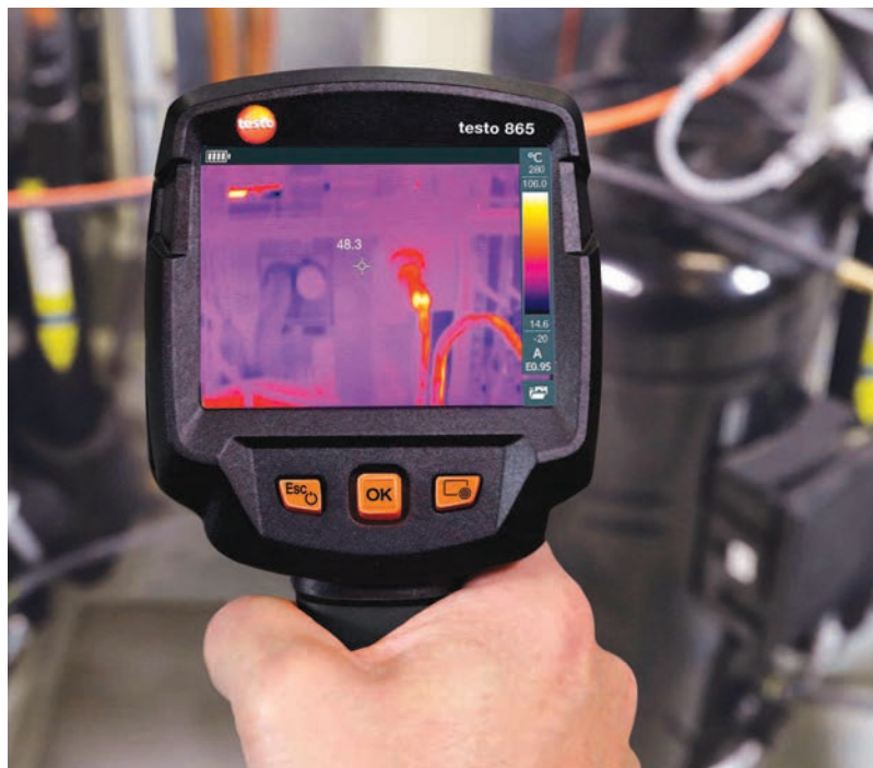
Cameră de imagistică termică Testo 865, -20 → +280°C, 160 × 120 pixeli
