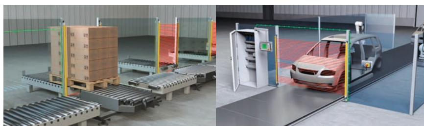
Controlarea procesului în intralogistică folosind Smart Process Gating
