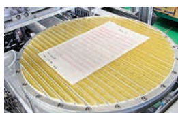
Măsurarea distribuției presiunii în curățarea panourilor LCD
