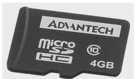
Figura 7 Cardul microSD SQF-MSDM1-4G-21C SQFlash de la Advantech dispune de 4 GB de memorie și se încadrează în Clasa 10 de viteză de scriere.
