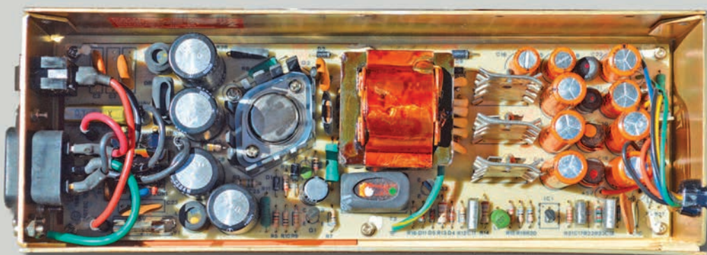
Figura 4: Sursa de putere în comutație de 38W de pe Apple II cu izolare galvanică (flyback) și ieșiri multiple proiectată de Rob Holt
